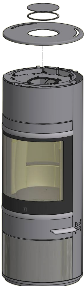
Løft topplaten av vedovnen.
