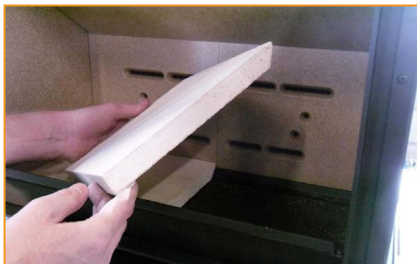
Bunnstenen settes inn med den skrå kanten bakover og nedover
