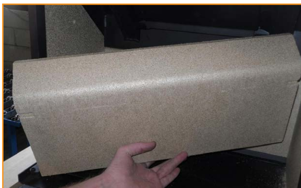
Nederste hvelv monteres. hvelven skal støtte seg på bakplaten. Stifter monteres og hvelv legges på plass
