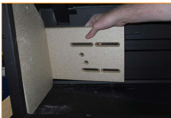
Bakplate settes inn. Sideplaten holder bakplaten på plass, så den ikke velter
